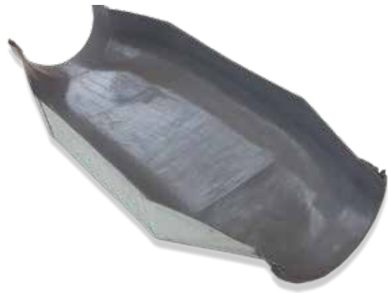
Genomskärning av rör tätat med Linerventmetoden
