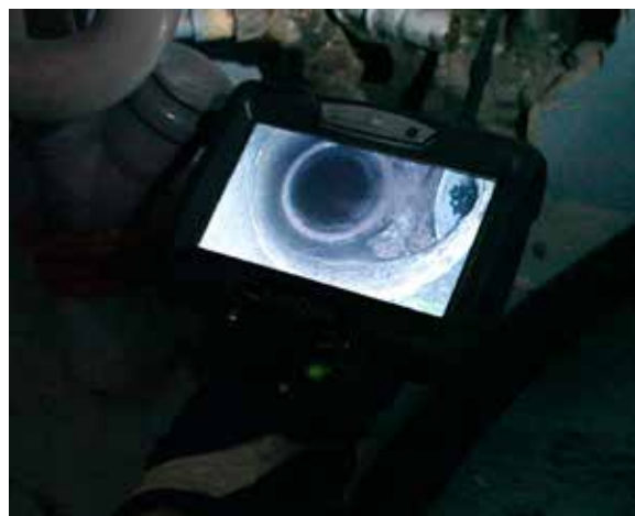
Granskning med inspektionskamera
